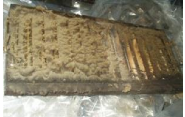
グリス除去装置のフィルターが目詰まりした状態
