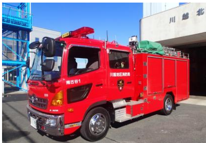
☆1号車（水槽付ポンプ車） （日野・H23年式・水1500ℓ積載）
