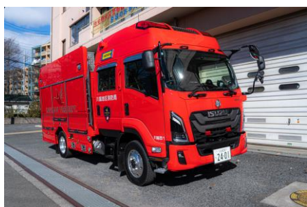
☆1号車（水槽付ポンプ車） （いすゞ・R7年式・水1500ℓ積載）
