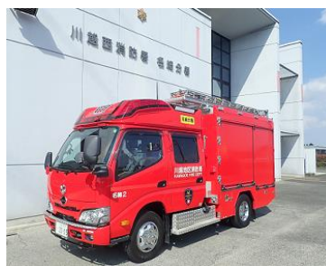
☆2号車（ポンプ車） （日野・R2年式・水600ℓ積載・ 圧縮空気泡消火装置付）
