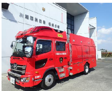
☆1号車（水槽付ポンプ車） （日野・H30年式・水1500ℓ積載）
