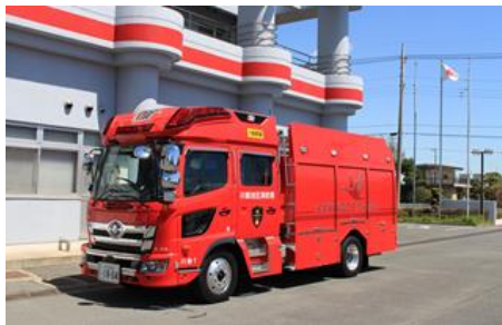
☆1号車（水槽付ポンプ車） （日野・H31年式・水1500ℓ積載）
