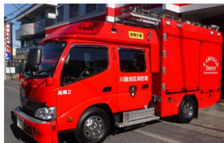
☆2号車（ポン7車） （日野・H24年式・水600ℓ積載・圧縮空気泡消火装置付）
