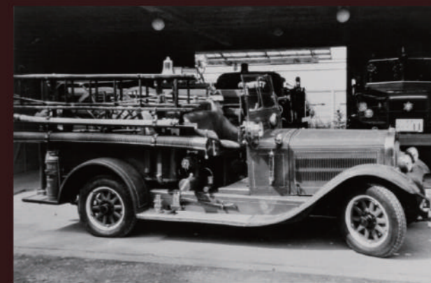
消防装備が架装されたハドソン号。木製スポークのタイヤホイールは当時としても珍しいものでした。
