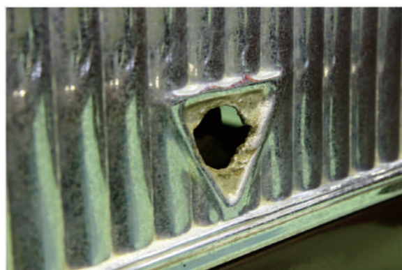
ハドソン号のフロントグリル下部にある穴。ここにクランク棒(スターティングハンドル)を差し込みエンジンを始動した。
