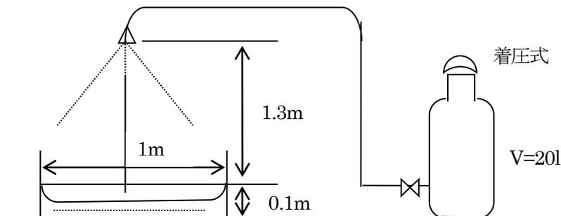
消火試験器材配置図
