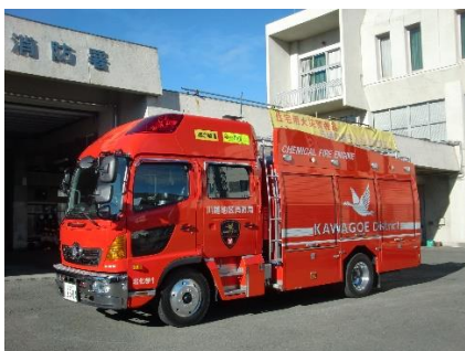
☆化学車（水槽付ポンプ車）
