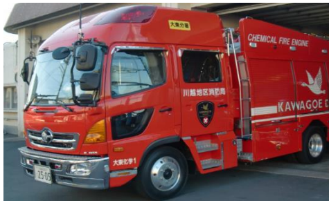
☆化学車（水槽付ポンプ車） （日野・H26年式・水1500ℓ・薬液500ℓ積載）
