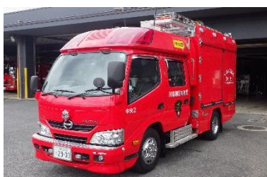
☆2号車（ポンプ車） （日野・H29年式 水600ℓ積載・圧縮空気泡消火装置付）
