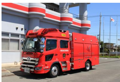
☆1号車（水槽付ポンプ車） （日野・H31年式・水1500ℓ積載）
