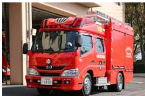
☆2号車（ポンプ車） （日野・H30年式・水600ℓ積載・圧縮空気泡消火装置付）
