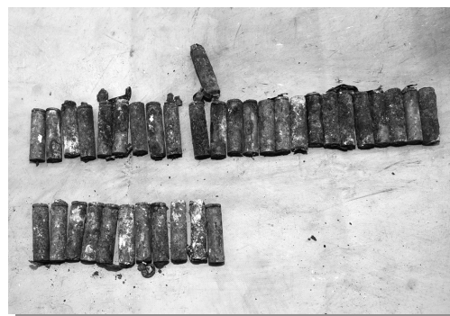
家庭用蓄電池に内蔵されている リチウムイオン電池の焼損状況
