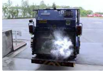
ゴミ収集車車内の発火事故の再現
