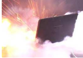
非純正品バッテリー搭載製品の発火事故の再現
