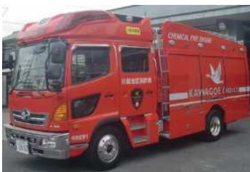
☆化学車（水槽付ポンプ車） （日野・H29年式・水1500ℓ積載 ・薬液500ℓ積載）
