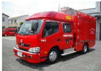
☆2号車（ポンプ車） （日野・H29年式・水600ℓ積載 ・圧縮空気泡消火装置付）
