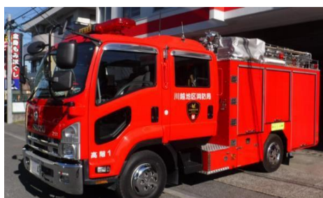
☆1号車（水槽付ポンプ車） （いすゞ・H22年式・水1500ℓ積載）
