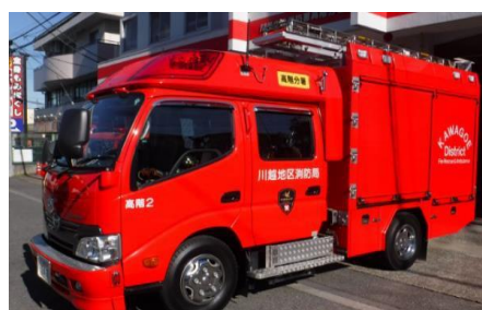
☆2号車（ポンプ車） （日野・H24年式・水600ℓ積載・圧縮空気泡消火装置付）
