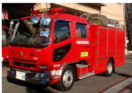
☆1号車（水槽付ポンプ車） （三菱・H21年式・水1500ℓ積載）
