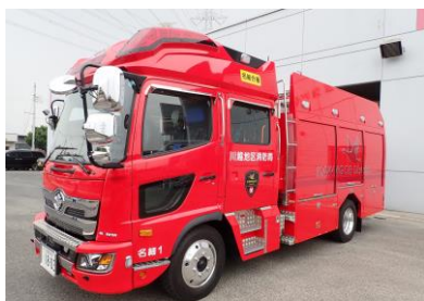
☆1号車（水槽付ポンプ車） （日野・H30年式・水1500ℓ積載）
