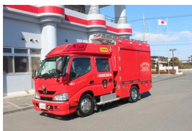
☆2号車（ポンプ車） （日野・H28年式 水600ℓ積載・圧縮空気泡消火装置付）
