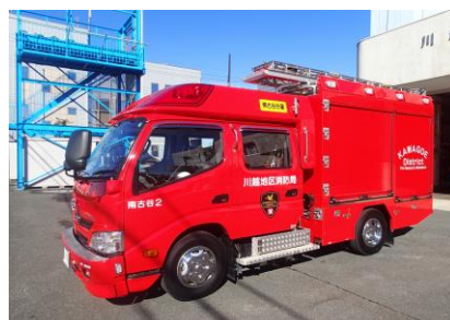
☆2号車（ポンプ車） （日野・H27年式・水600ℓ積載・圧縮空気泡消火装置付）
