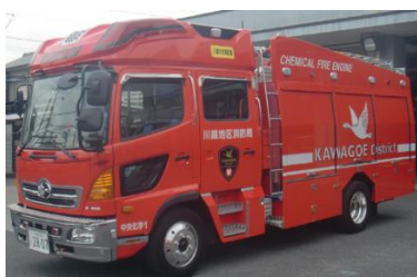
☆化学車（水槽付ポンプ車） （日野・H29年式 水1500ℓ・薬液500ℓ積載）
