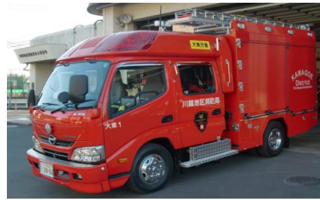
☆1号車（ポンプ車） （日野・H28年式・水600ℓ積載・圧縮空気泡消火装置付）
