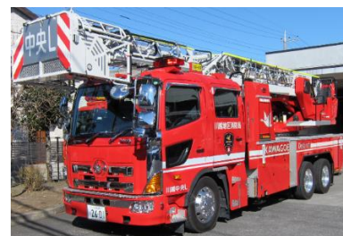
☆はしご車（先端屈折） （日野・H27年式・地上高30.5m）
