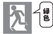
避難口誘導灯
